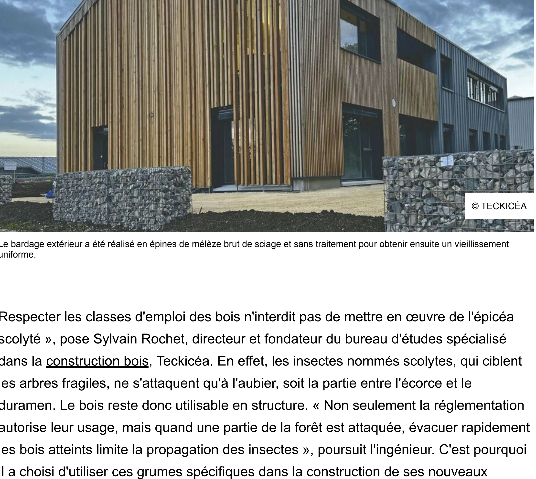
Le bardage extérieur a été réalisé en épinus de mélèze brut de sciage et sans traitement pour obtenir ensuite un vieillissement uniforme.
